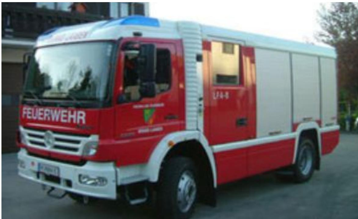
Bezeichnung: LFA Löschfahrzeug Allrad
